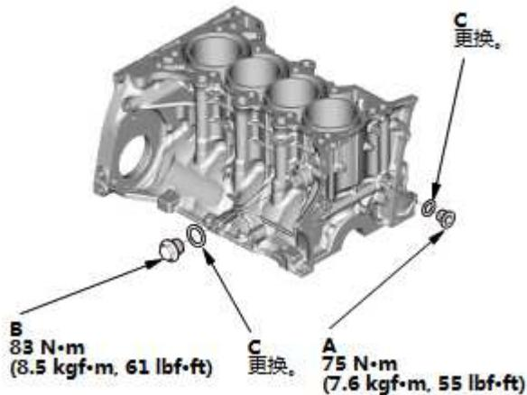
2. 所有拆下零件 - 安装
